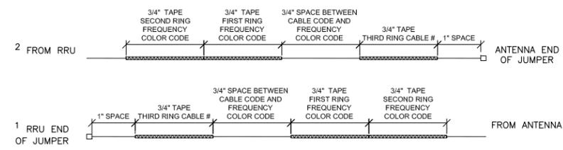
JUMPER CABLE CONNECTION AT RRU AND ANTENNA
