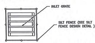
IP-4. SILT FENCE FOR SUMP INLET PROTECTION
