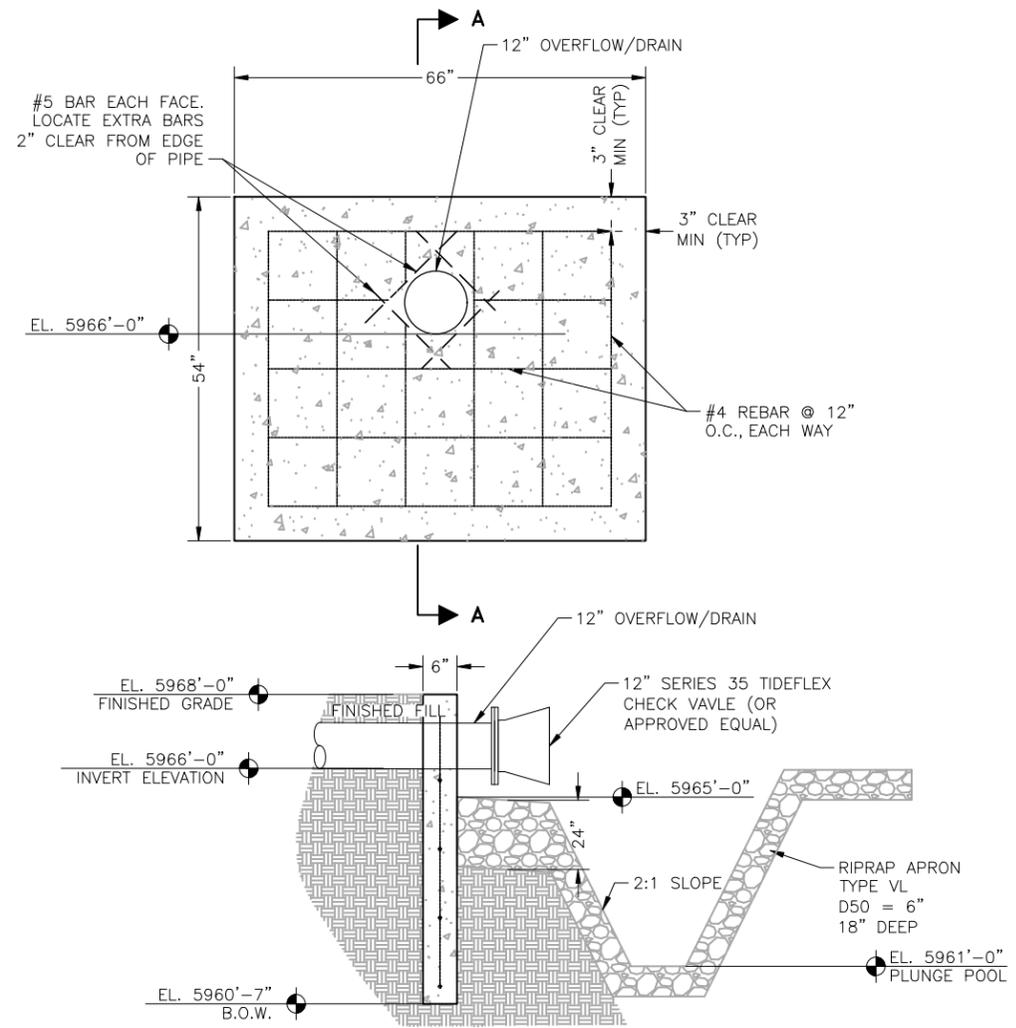
B CONCRETE HEADWALL AND PLUNGE POOL
