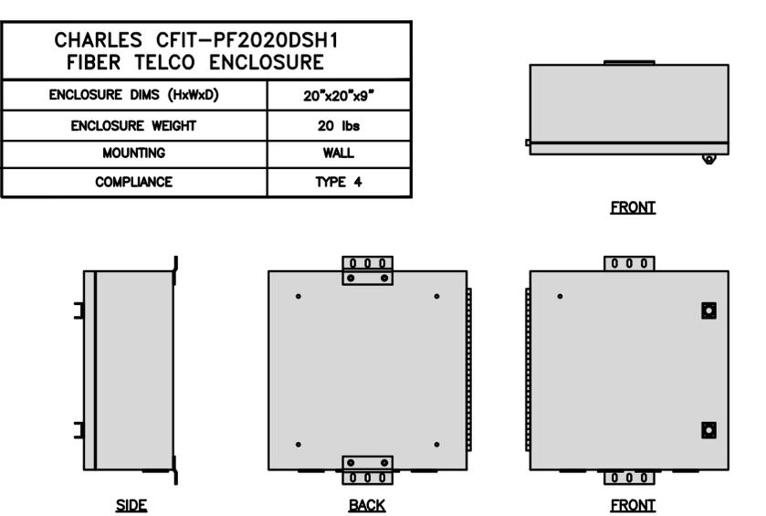
**FIBER TELCO ENCLOSURE DETAIL**      NO SCALE      6
