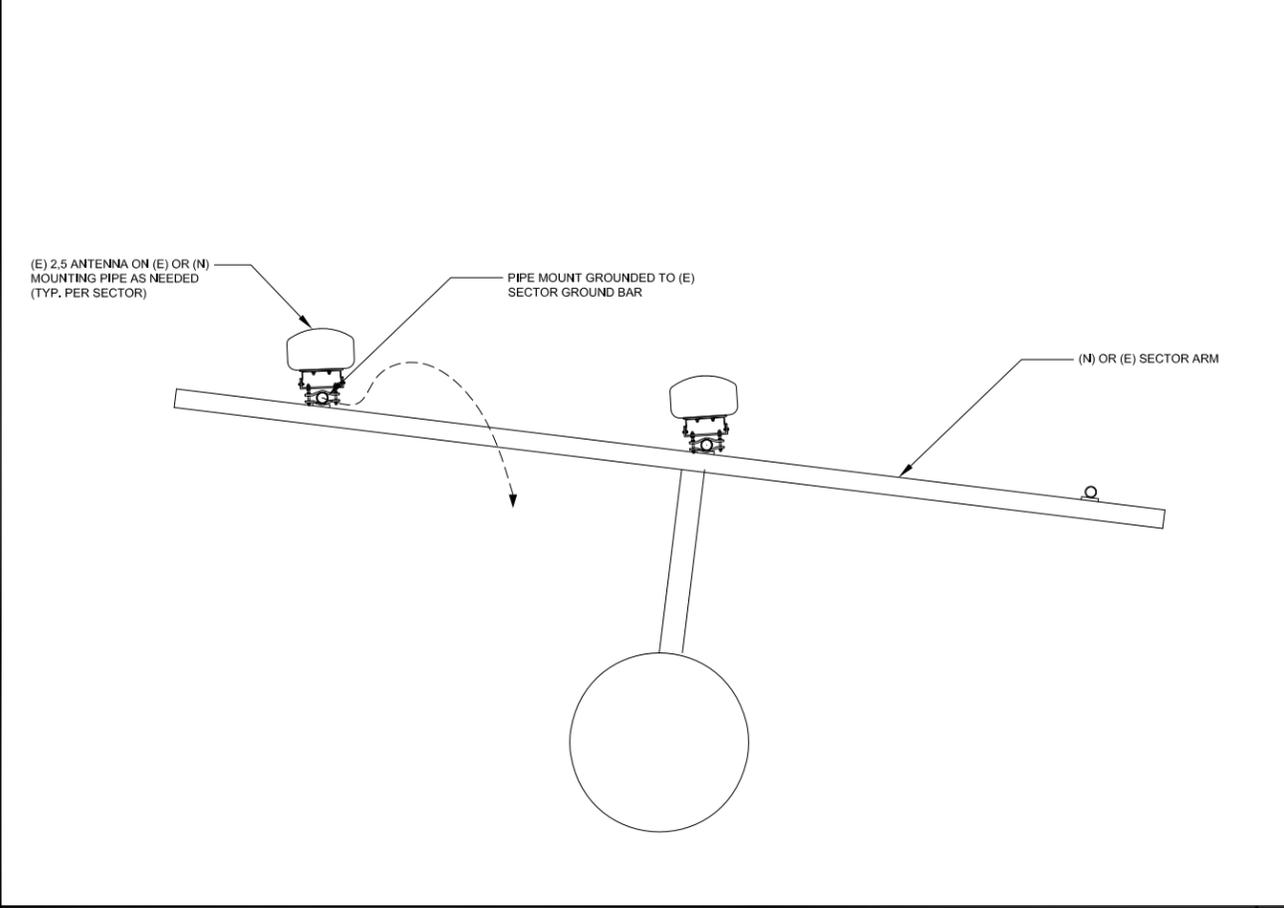
**TYPICAL ANTENNA GROUNDING PLAN**
