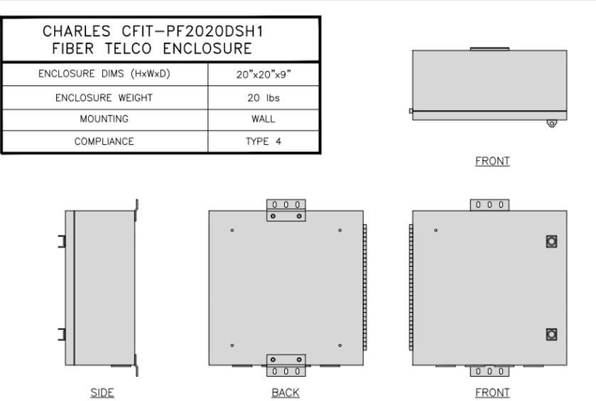
FIBER TELCO ENCLOSURE DETAIL      NO SCALE      6
