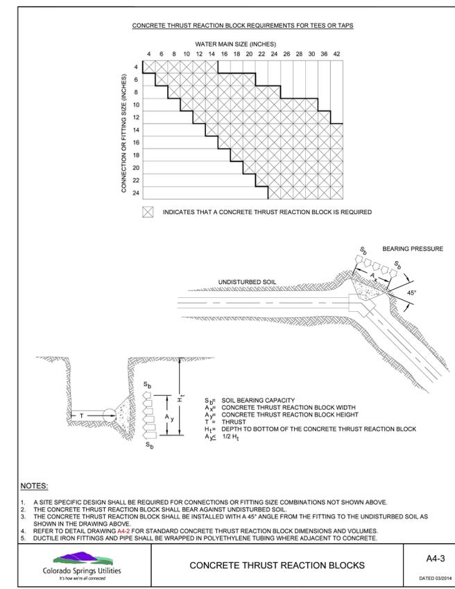
**CONCRETE THRUST REACTION BLOCKS**
