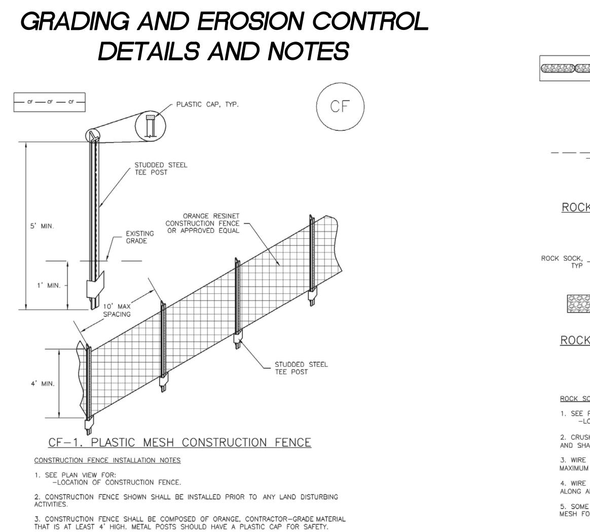
4. STUDDED STEEL TEE POSTS SHALL BE UTILIZED TO SUPPORT THE CONSTRUCTION FENCE. MAXIMUM SPACING FOR STEEL TEE POSTS SHALL BE 10'.
