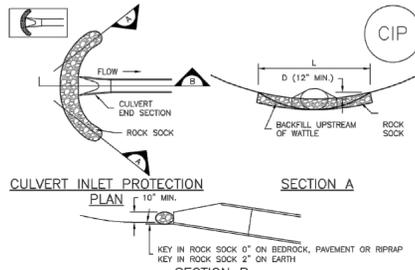
**CIP-1. CULVERT INLET PROTECTION**
