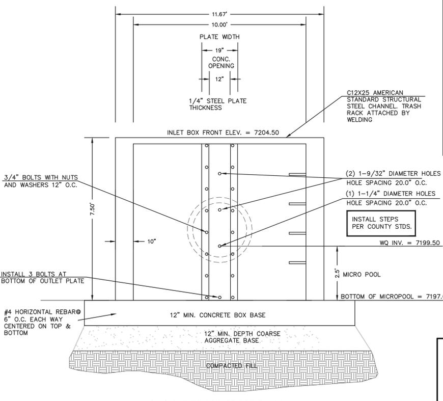
**10'X4' OUTLET BOX ORIFICE PLATE**
