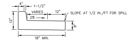
SPLITTER ISLAND CURB/GUTTER (SPILL)
