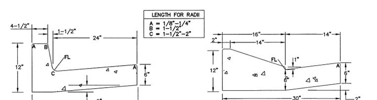
**EPC TYPE A CURB & GUTTER DETAIL**
