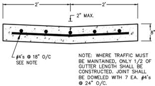
TYPICAL CONCRETE CROSSSPAN (1)
