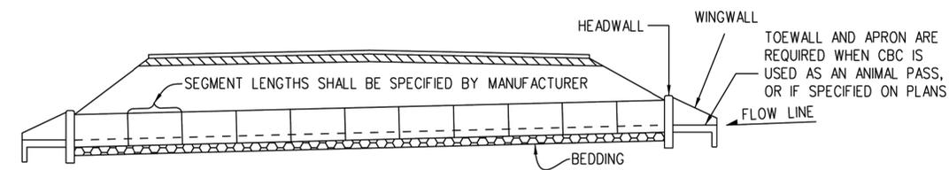
TYPICAL CULVERT INSTALLATION
