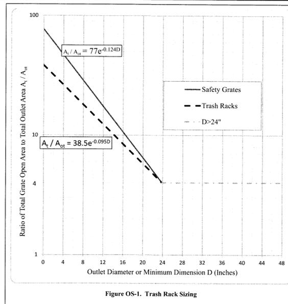
FIGURE OS-1. TRASH RACK SIZING
