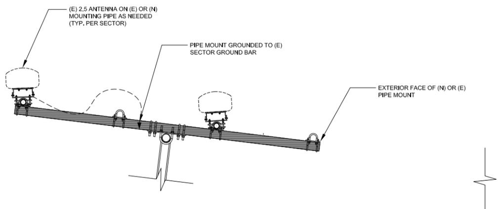
**TYPICAL ANTENNA GROUNDING PLAN**
