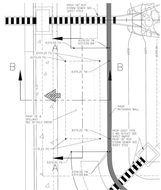
**LOT 2 - SAND FILTER POND 3 SPILLWAY PLAN**
