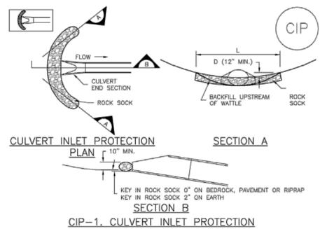
**CIP-1. CULVERT INLET PROTECTION**
