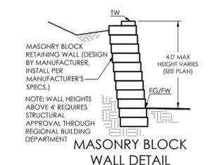
**MASONRY BLOCK WALL DETAIL**
