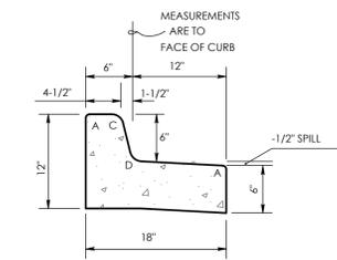
**SPILL CURB & GUTTER**
