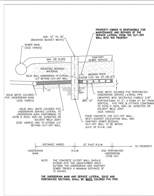
**UNDER DRAIN CUT-OFF WALL DETAIL**
