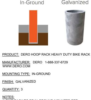
1. BIKE RACK TO BE IN-GROUND MOUNTED PER MANUFACTURER'S SPECIFICATIONS. 2. BIKE RACK FINISH TO BE GALVANIZED.
