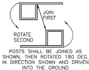
POSTS SHALL OVERLAP AT JOINTS SO THAT NO GAPS EXIST IN SILT FENCE
