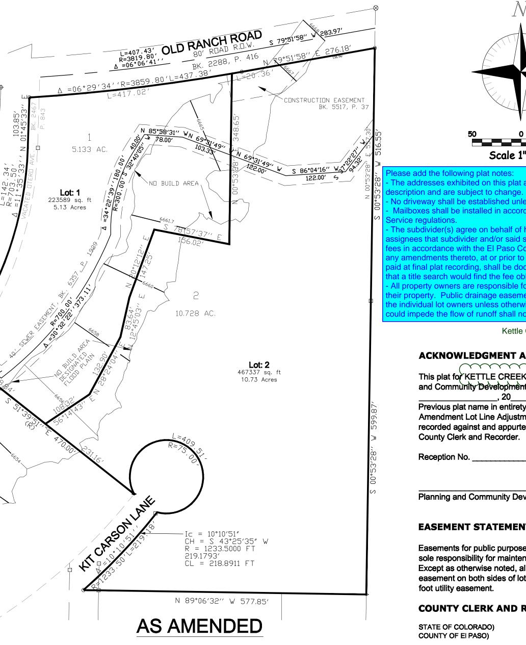
1.) BEARINGS SHOWN ARE BASED UPON THE EAST LINE OF LOTS 7 & 8, SPRING CREST AMENDED FILING, BEING S 00°53'28" W, PER RECORDED PLAT, BETWEEN THE FOUND 1/2" IRON PIPE AND THE FOUND 1" CAP L.S. NO. 37988 AS SHOWN HEREON.
