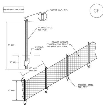
CF-1. PLASTIC MESH CONSTRUCTION FENCE
