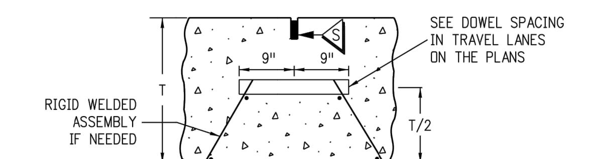
DOWELED TRANSVERSE CONSTRUCTION OR CONTRACTION JOINT
