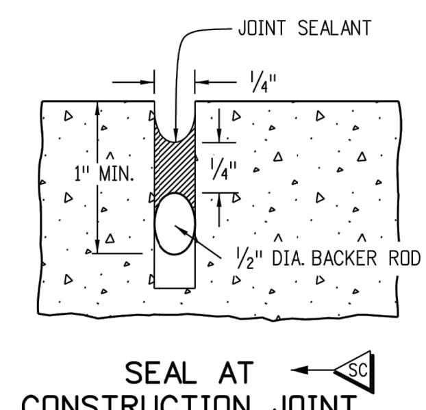
SEAL AT CONSTRUCTION JOINT
