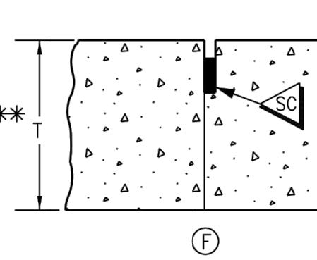
LONGITUDINAL CONSTRUCTION JOINT
