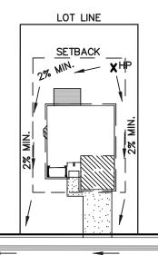
NOTES: 1. SIDEYARD SWALES TO BE CONST. AT 2% MIN. SLOPE.
