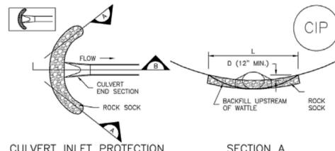
**CIP-1. CULVERT INLET PROTECTION**
