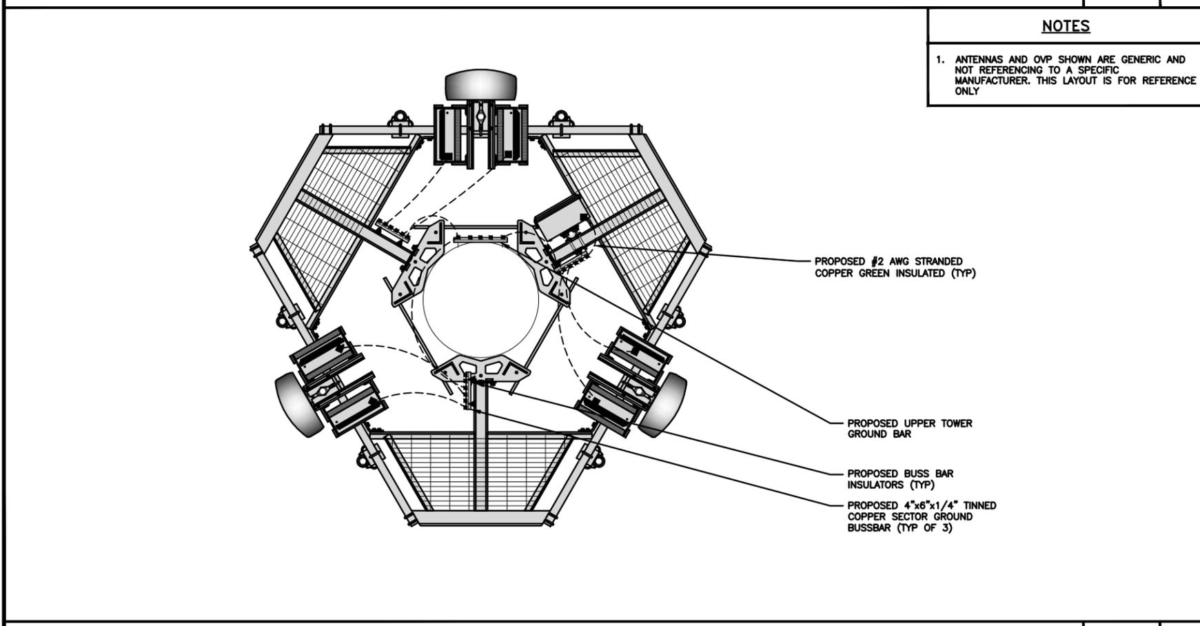
**TYPICAL ANTENNA GROUNDING PLAN**
