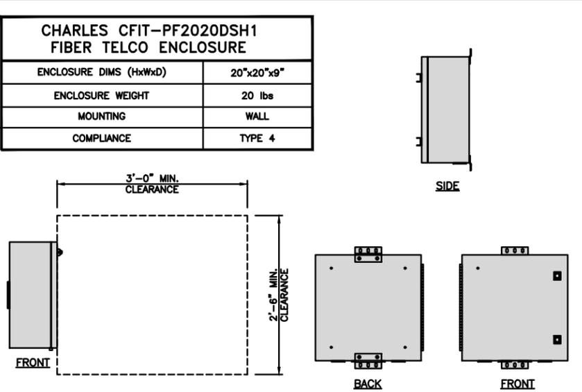
**FIBER TELCO ENCLOSURE DETAIL**      NO SCALE      6
