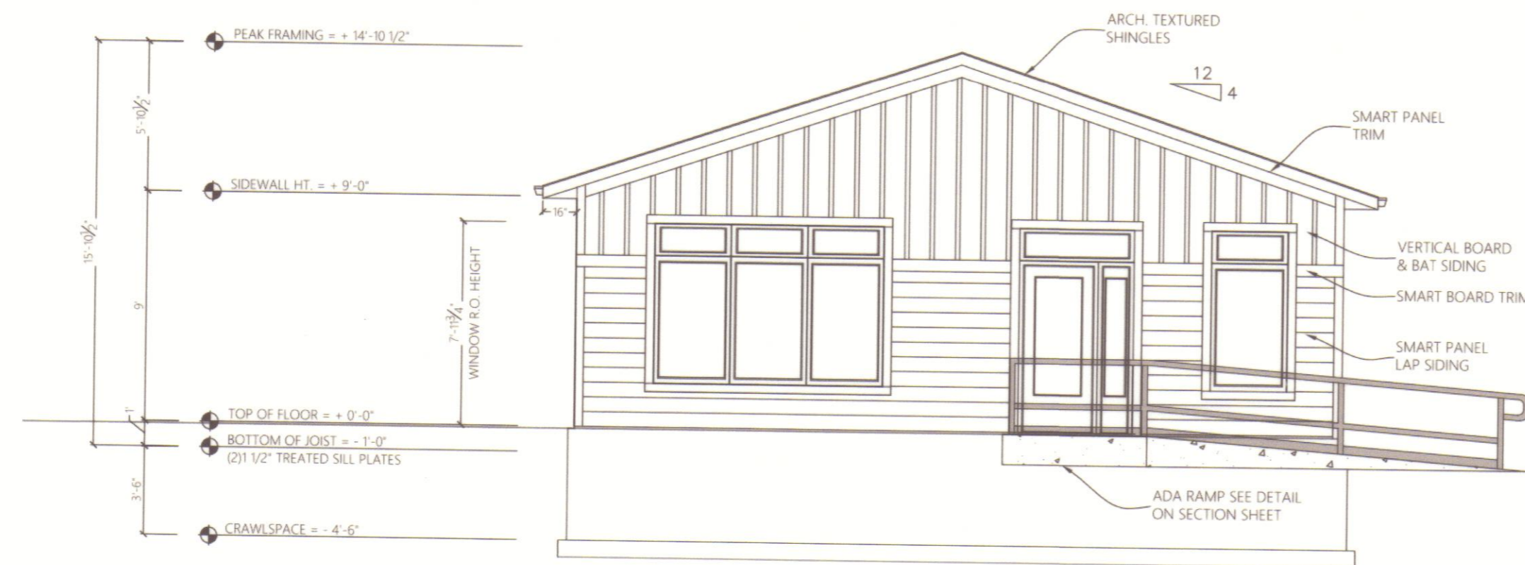
FRONT ELEVATION SCALE: 1/4" = 1'0"
