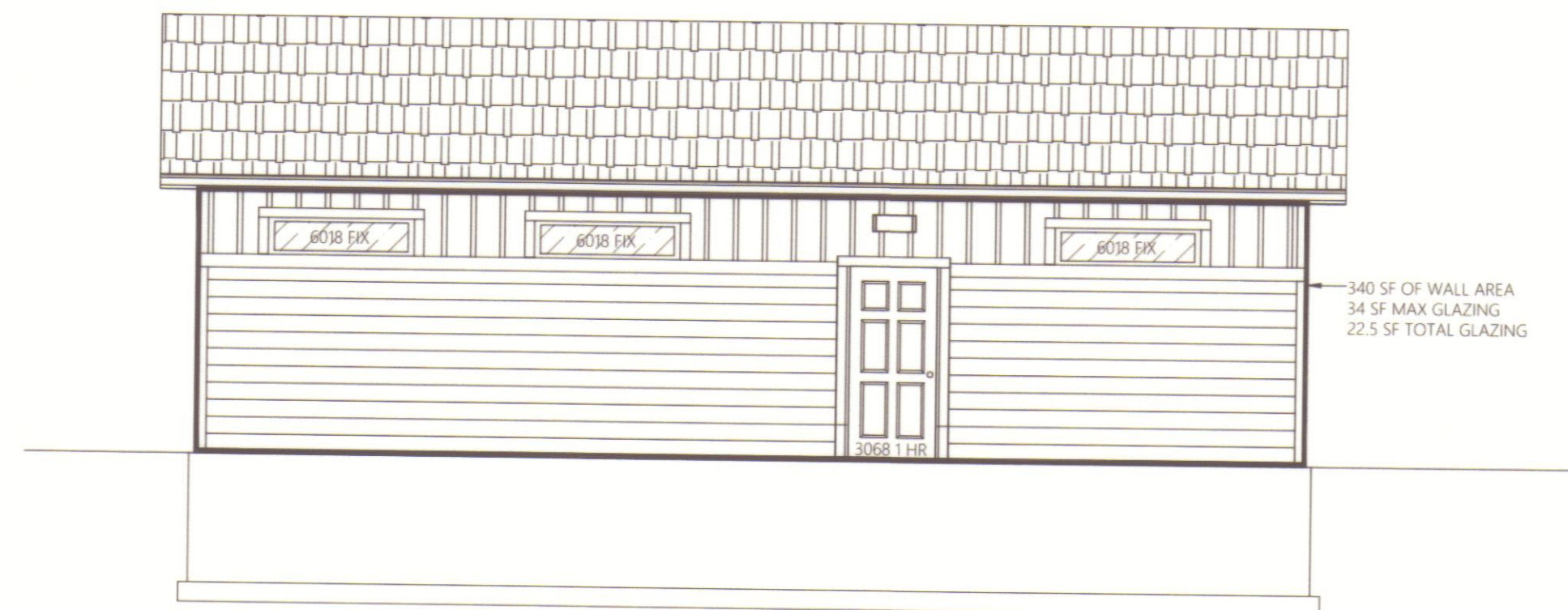
LEFT ELEVATION SCALE: 1/4" = 1'0"
