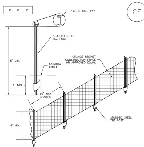
CF-1. PLASTIC MESH CONSTRUCTION FENCE
