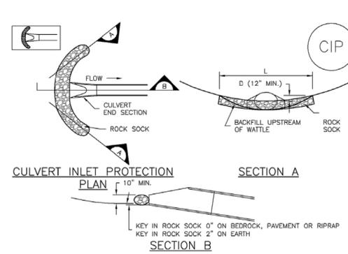
**CIP-1. CULVERT INLET PROTECTION**
